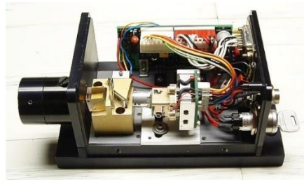
Melles Griot 社製 58GCS シリーズ緑色 DPSS レーザーの内部
