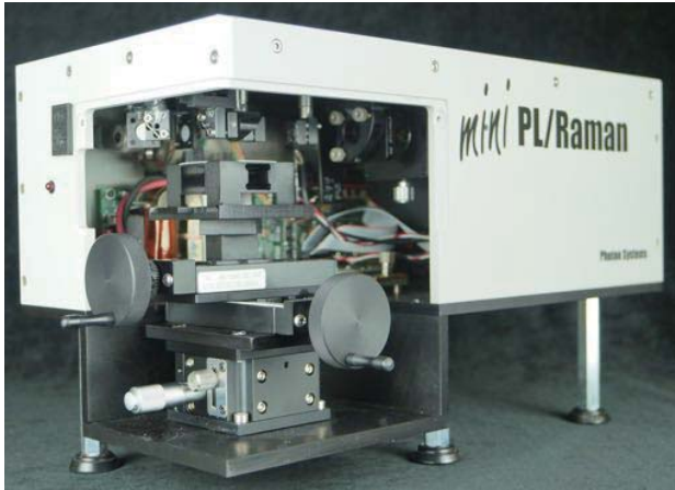
Mini PL / ラマン分光装置標準構成は、高精度マニュアルステージを備えます
