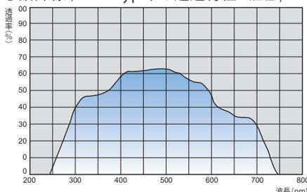
300nmよりも短波長側の紫外線を使用する場合や、使用する光源に300nm以下の波長が含まれる場合にはこちらのタイプをご使用下さい。使用開始時の透過率はS-typeよりも若干落ちますが長寿命です。
