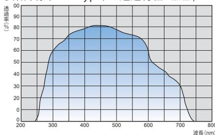
300nmよりも長波長側の紫外線を使用する場合はこちらのタイプをご使用下さい。使用開始時の透過率がD-typeよりも高くなっています。
