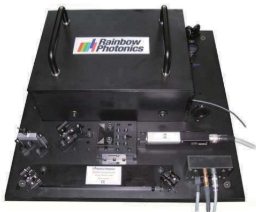
図7:TeraKit®の光学板(寸法:38cm X 38cm)
