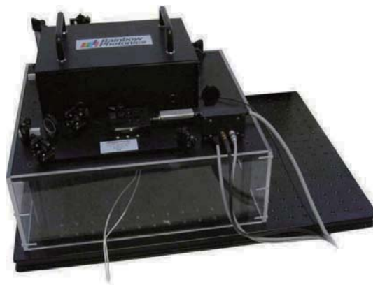
図8:TeraIMAGE®の光学板(スキャニング範囲:50mm X 50mm)
