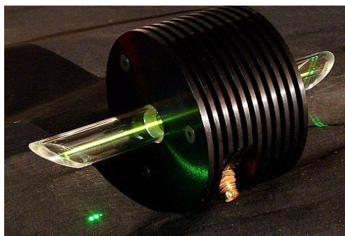
HP/Agilent 社製 5517A ISHL 内のヨウ素セル
