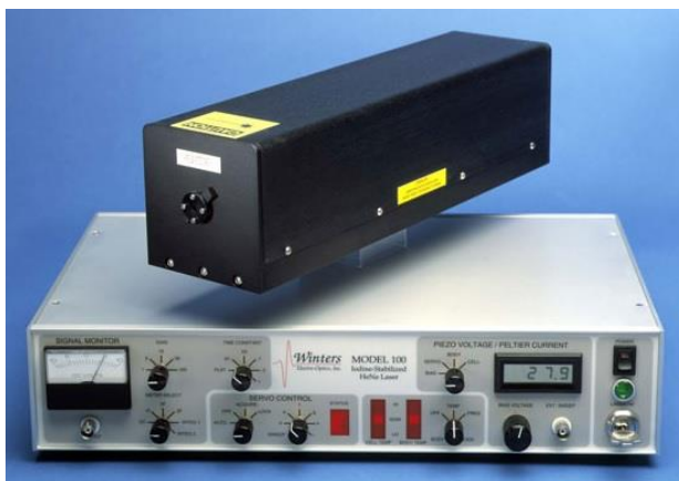
Winters Electro-Optics 社製 100 ヨウ素安定化 HeNe レーザー
