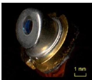
SONY 製 KSS361A 光学ピックアップ用の半導体レーザーのクローズアップ
