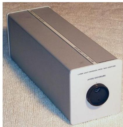
Agilent 社製 5517 測距用ゼーマン分離レーザーの外観
