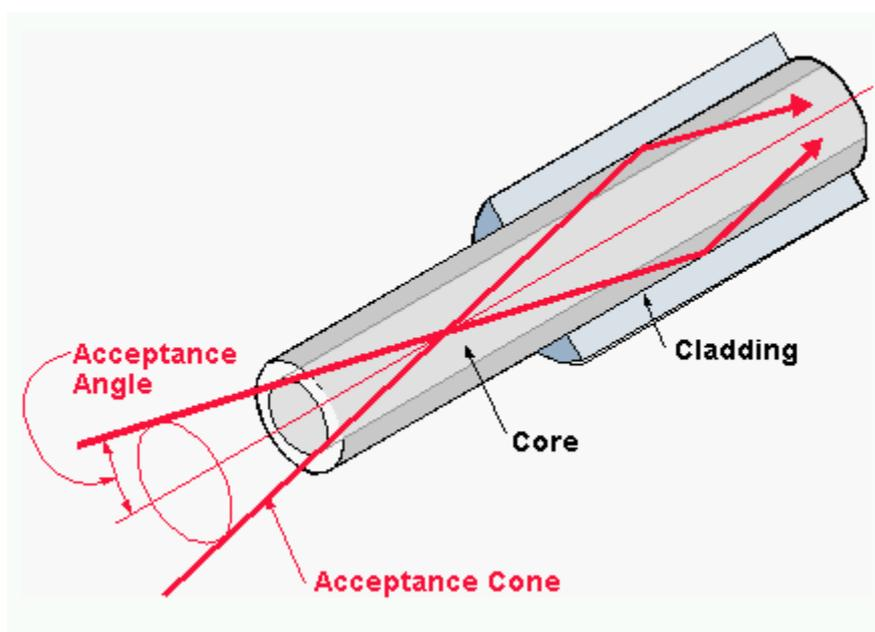
図2: ポリファイバーの構造と入射角
