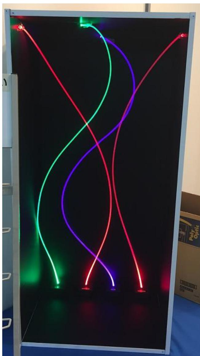
図1:ポリファイバーでのイルミネーション例
