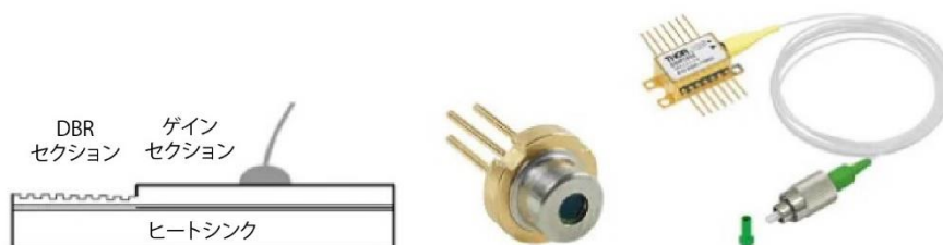
図 1 DBR ダイオードレーザゲインチップの構造図と DBR ダイオードレーザの標準パッケージ例
