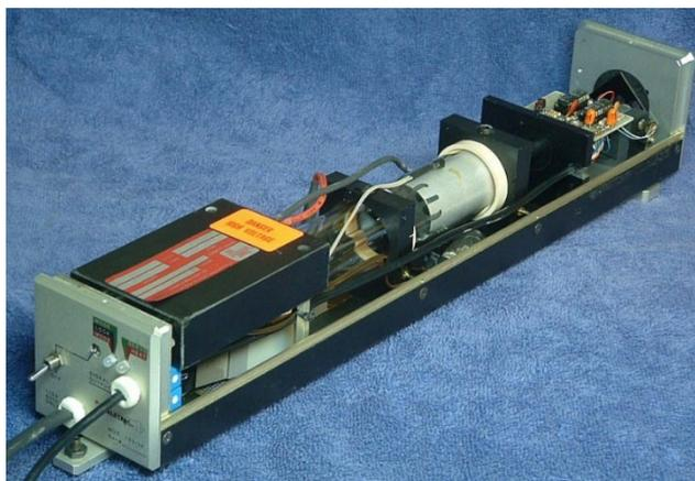
Teletrack 社製 150 安定化 HeNe レーザーの内部写真
