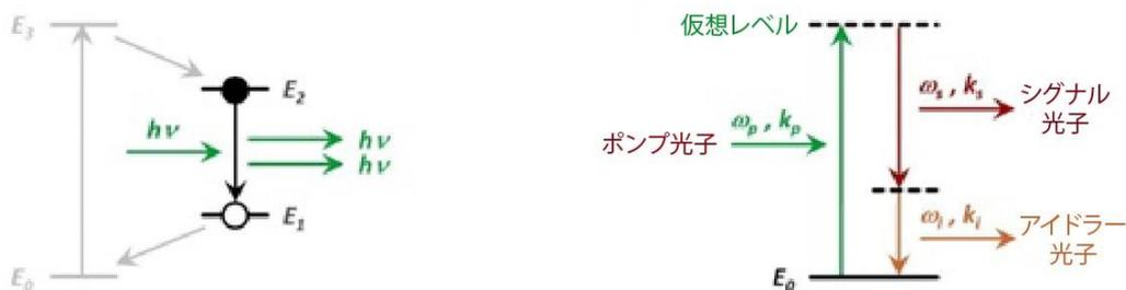
図 1. 左: 4準位利得媒質におけるレーザー発振の概略図。このプロセスは、反転分布 (光ポンピングなどによって維持される) と誘導放出に基づいています。右: 非線形媒体における光パラメトリック変換の概略図。直感的に説明すると、ポンプレーザー光子は、一般にシグナル光子 ( $\omega_s, k_s$ ) とアイドラー光子 ( $\omega_i, k_i$ ) と呼ばれる、よりエネルギーの低い光子のペアに分割されます。ポンプ波、シグナル波、およびアイドラー波のこのいわゆる三波混合は、使用される非線形結晶の二次非線形性に密接に関係しています。このプロセスは光子エネルギー ( $\omega_p = \omega_s + \omega_i$ ) と光子の運動量 ( $k_p = k_s + k_i$ ) の変換の影響を受けますが、それ以外の場合、シグナル/アイドラーペアの動作波長は原理的に自由に選択でき、継続的にスペクトル調整が為されます。
