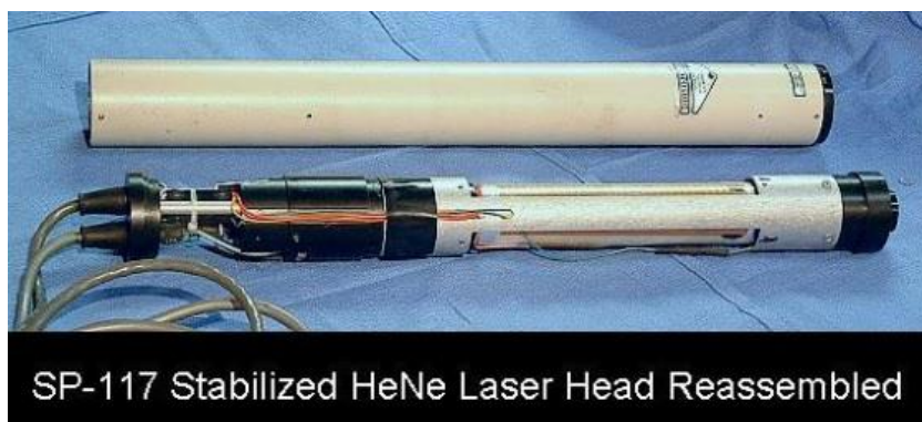
Spectra Physics 社製 SP-117 ヘッドの内部写真
